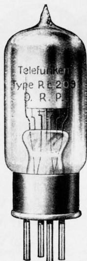
Verwendungszweck: Spezial-Endröhre (letzte Niederfrequenzstufe) für Lautsprecherbetrieb, wo große Lautstärke erzielbar ist. Negative Gittervorspannung von  $-5$  bis  $-14$  Volt je nach Anodenspannung erforderlich.
