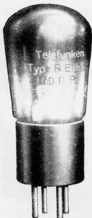
Verwendungszweck: Spezial-Verstärker-Röhre für widerstandsgekoppelte Niederfrequenzverstärker. Zu verbinden mit RE 154 oder RE 504 für die Endstufe.
