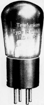
Verwendungszweck: für Anfangsstufen (Hochfrequenzstufen, Audion- und Niederfrequenzstufen bis zu mittleren Leistungen), zu verbinden mit der Röhre RE 152 für die letzte Niederfrequenzstufe (als Lautsprecherröhre).
