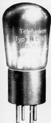
Verwendungszweck: für Anfangsstufen (Hochfrequenzstufen, Audion und Niederfrequenzstufen bis zu mittleren Leistungen); zu verbinden mit RE 154 oder RE 504 (früher RE 209) für letzte Niederfrequenzstufe (als Lautsprecherröhre).
