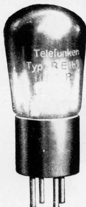
Verwendungszweck: Schwingröhre für Überlagerer und Zwischenfrequenz-(Superheterodyn-)Empfänger. Hochfrequenz- und Audionröhre für Mehrröhrenempfänger, wo besonders große Leistung oder hohe Lebensdauer erwünscht ist.
