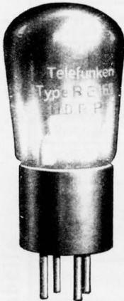
Verwendungszweck: Als zweitletzte Niederfrequenzstufe bei Mehrrohrgeräten oder als letzte Niederfrequenzröhre für Lautsprecherbetrieb. In diesem Fall ist eine negative Gittervorspannung von  $-3\text{ V}$  bis  $-6\text{ V}$  erforderlich. Zu verbinden mit RE 064 für die Anfangsstufen.
