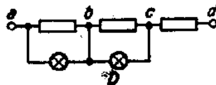
Bild 39. Octalsockel a b c d Octalsockel Y 7 8 2 3 Octalsockel Z 8 1 2 4 4-Stift-Sockel X 4 3 2 4
