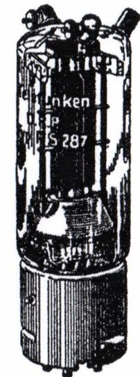
\*) 12,6 Volt ist die Normalheizspannung, auf die sämtliche Betriebsdaten bezogen sind. Maximal sind Heizspannungsschwankungen zwischen 11 und 13,5 Volt zugelassen, jedoch vermindert Dauerbetrieb mit diesen Grenzwerten die durchschnittliche Lebensdauer der Röhren.
