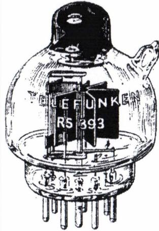
\*) 12,6 Volt ist die Normalheizspannung, auf die sämtliche Betriebsdaten bezogen sind. Maximal sind Heizspannungsschwankungen zwischen 10,8 und 14,5 Volt zulässig. jedoch vermindert Dauerbetrieb mit diesen Grenzwerten die durchschnittliche Lebensdauer der Röhre.
