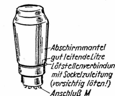
Bild 3. Nachträgliches Verbinden der Zuleitung zwischen Abschirmung und Sockelkontakt
