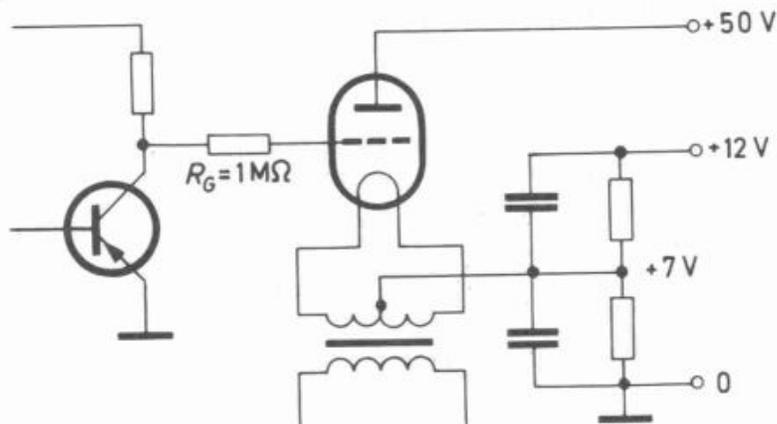
Abb. 3 zeigt eine Abänderung der 2. Schaltung für Fälle, bei denen die Ansteuerungsspannung  $< 3\text{ V}$  ist. In diesen Fällen ergibt sich durch den Streubereich des L-Potentials ein entsprechender Streubereich in der Leuchtdichte der Anzeige. In dieser Schaltung liegt das L-Potential zwischen  $+2$  und  $+7\text{ V}$ , das 0-Potential zwischen  $0$  und  $+0,5\text{ V}$ .
