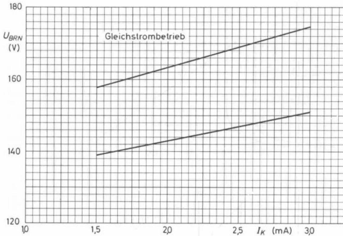
Die folgenden Kennlinien zeigen die Abhängigkeit des Stromes über eine nicht gezündete Katode von der Vorspannung an den nicht gezündeten Katoden für Gleichstrombetrieb.
