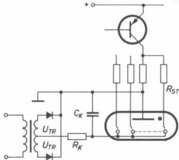
Die Zündelektroden-Vorspannung darf vom Anodenpotential um max.  $\pm$  5 V abweichen.
