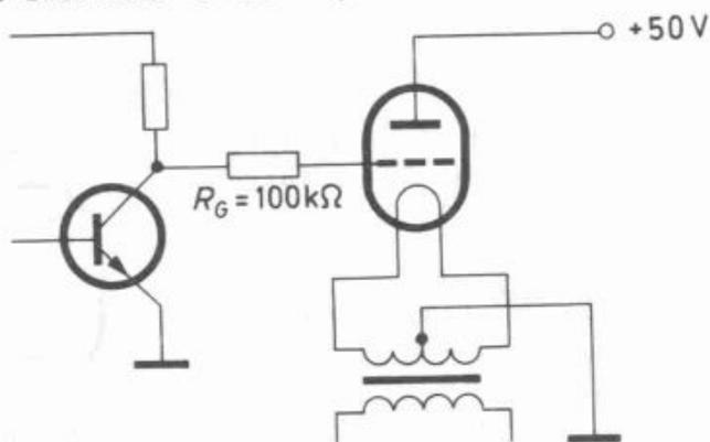
Abb. 2 zeigt eine digitale Ansteuerung von Flipflops mit NPN-Transistoren. Das L-Potential variiert zwischen  $+7,5$  und  $+12$  V, das 0-Potential zwischen 0 und  $+0,4$  V. Der Gitterwiderstand schützt die Röhre vor zu großen Anodenströmen und positivem Gitterstrom, wenn die Gitterspeisespannung über Kathodenpotential liegt.
