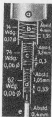
Bild 47. Beispiel für Systemabmessungen (AF 7). a = Anode, b = Bremsgitter, c = Schirmgitter, d = Steuergitter, e = Katode (Ratheiser)
