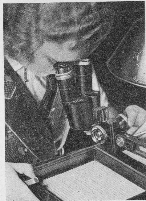
Bild 10. Kontrolle der mit Isolierpaste besprühten Brenner auf Gleichmäßigkeit der Isolierschicht (Telefunken)
